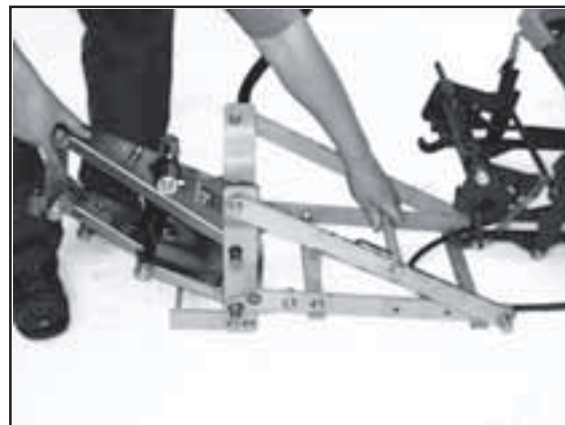
4) Räumschildträger aus dem Halter des Rasentraktors ziehen.
